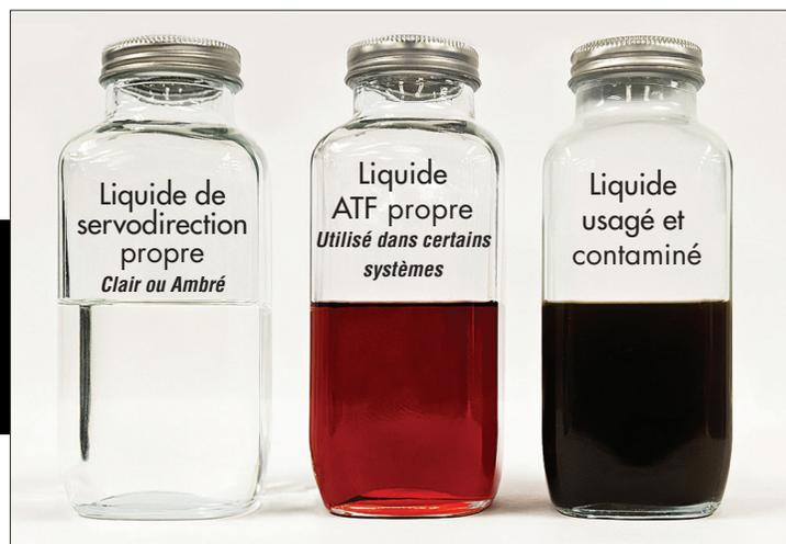
Un rinçage de 4 à 5 pintes de liquide dans le système permet d'éliminer les contaminants du système. Utiliser le type de fluide OE recommandé.
